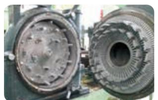
角ピン状の突起物が多数ついた板を高速回転させ製粉する。原料米は乾式で行う。
