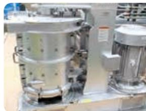
粉碎室内のブレードが高速回転し、粉碎された粉は気流にのって排出される。湿式・乾式粉碎の両方が可能。
