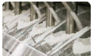
互いに1対の高速で回転する2本のロールの間に原料を通し、圧縮させて粉碎する。原料米は乾式で行う。
